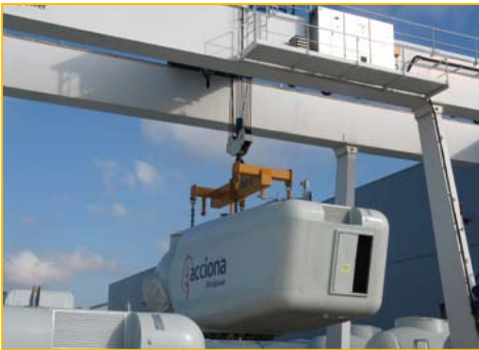
Траверса до 80 тонн для подъема и перемещения ветро-генератора на складе.
