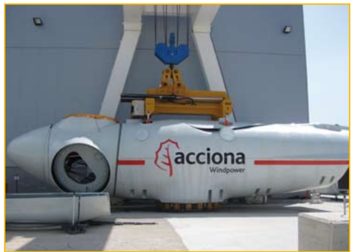
Траверса до 160 тонн с гидравлическим устройством на фабрике ветро-генераторов.
